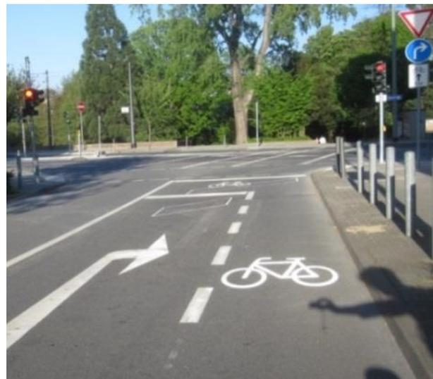
Abbildung 39 – aufgeweiteter Radaufstellstreifen in Frankfurt, Foto [VAR](#)
